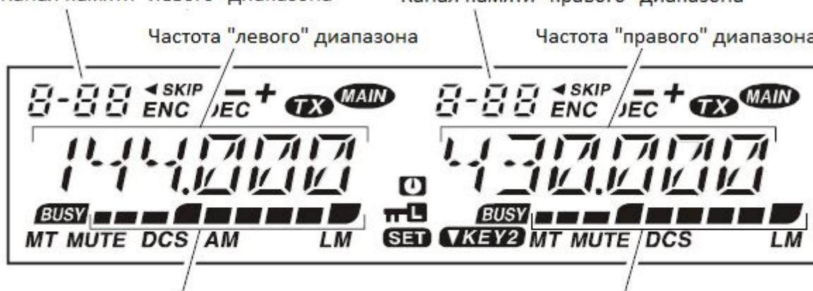
S-метр и индикатор мощности передачи "левого" диапазона
