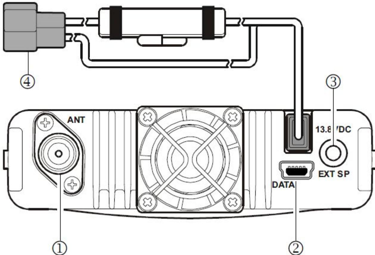
1. Разъем UHF Male-типа (PL-259) для подключения антенны.
